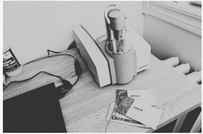
LE SPECTROMÈTRE PERMET DE DÉTERMINER LES COMPOSANTES D'UNE DROGUE VIA UNE LUMIÈRE INFRAROUGE. (MARIANE L. ST-GELAIS/LE QUOTIDIEN)
